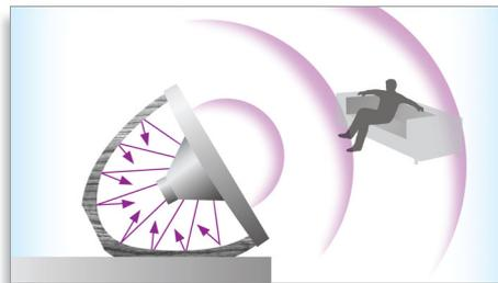
Il rivestimento posteriore ricurvo dalle linee ricercate crea una struttura acustica efficace per una riproduzione sonora ottimale. Le curve semplici rafforzano la rigidità della cassa degli altoparlanti riducendo in maniera sensibile la risonanza interna ed eliminando le vibrazioni e la distorsione audio. Potrai così ascoltare un audio cristallino con degli altoparlanti dal look mozzafiato.
